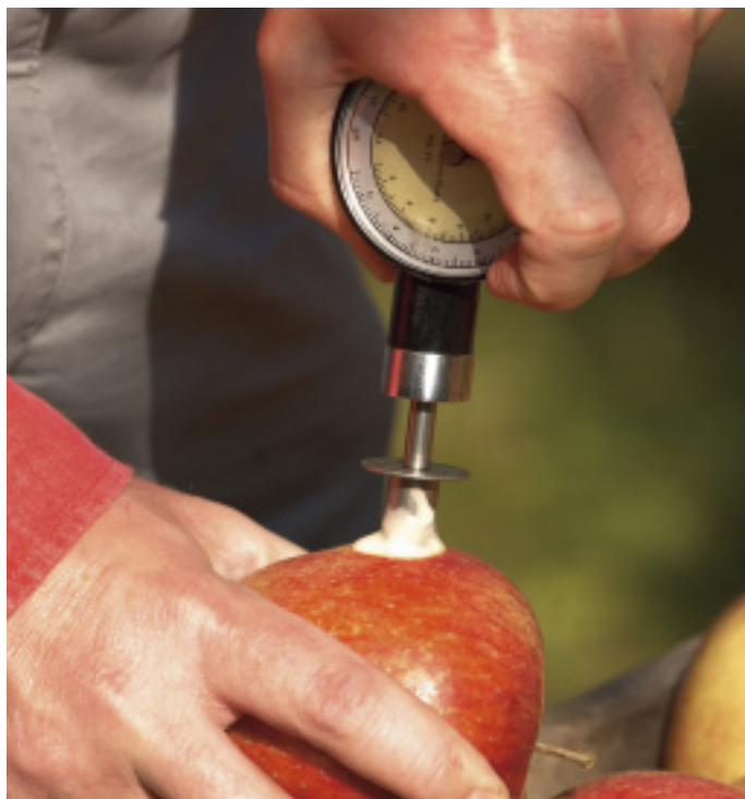
In de boomgaard gebruikt onze aankoper een penetrometer om de hardheid van het fruit te meten.
